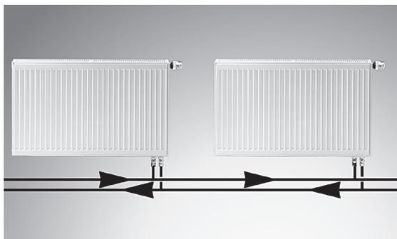
Рис. 24. Нижнее подключение в двухтрубной системе
