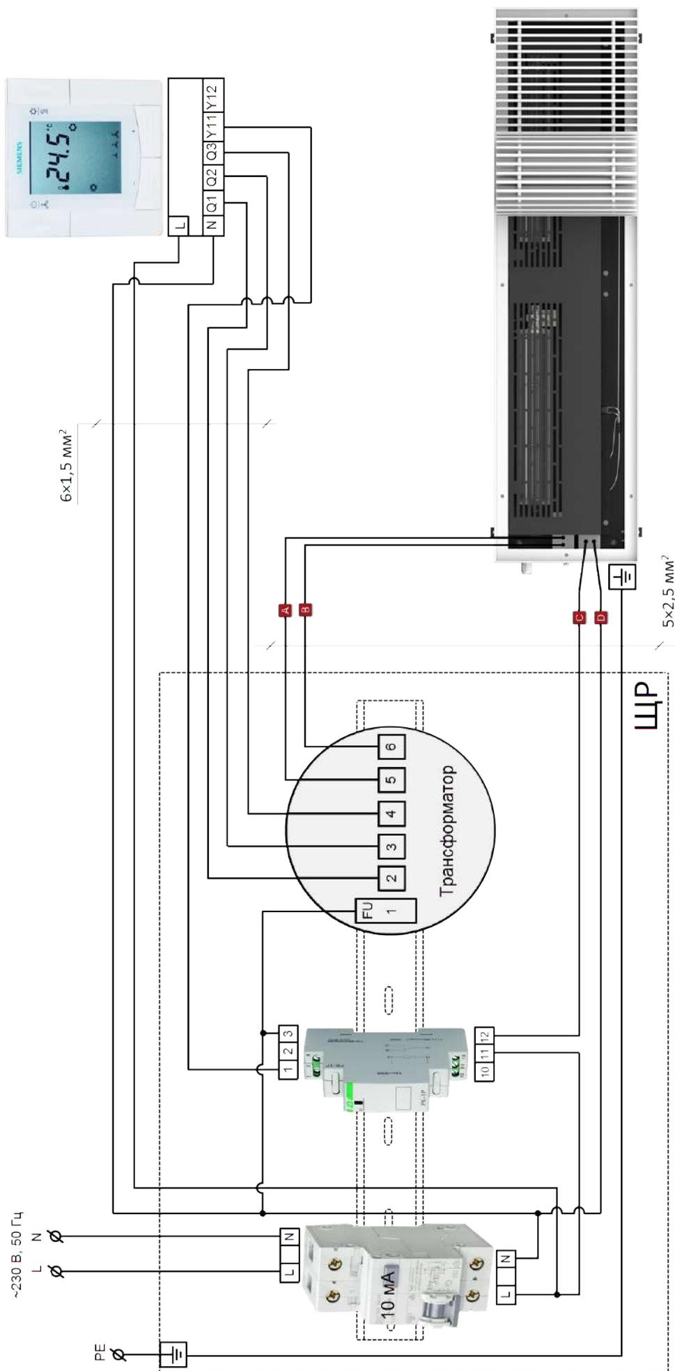
**Провода «А», «В» - подключить к вентилятору;
